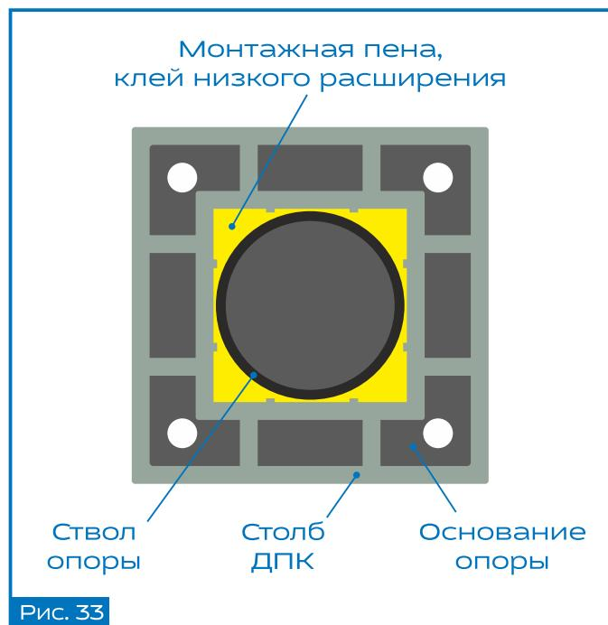
**2).** На установленную металлическую опору для столба, устанавливается столб ДПК (Рисунок 31) и при необходимости дополнительно фиксируется с помощью монтажной пены, клея низкого расширения (Рисунок 33). Пена либо клей закачиваются в полость между столбом и стволов опоры с помощью монтажного пистолета на глубину до 300 мм, после чего даётся некоторое время для отвердевания.
